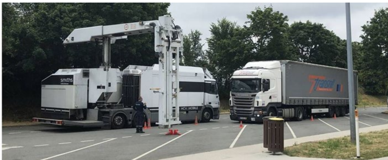
Opération de contrôle par la Douane française avec leur scanner mobile HCVM L à l'aire de repos de Saint-Goustan à Auray, dans le Morbihan, sur la RN165, permettant d'identifier plus facilement et plus précisément les menaces et les articles de contrebande. Photo Ouest-France
